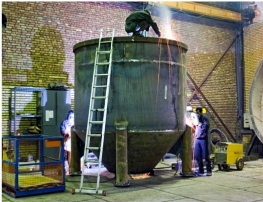
انواع مخازن و راکتورهای مواد شیمیایی از استیل ضد زنگ
