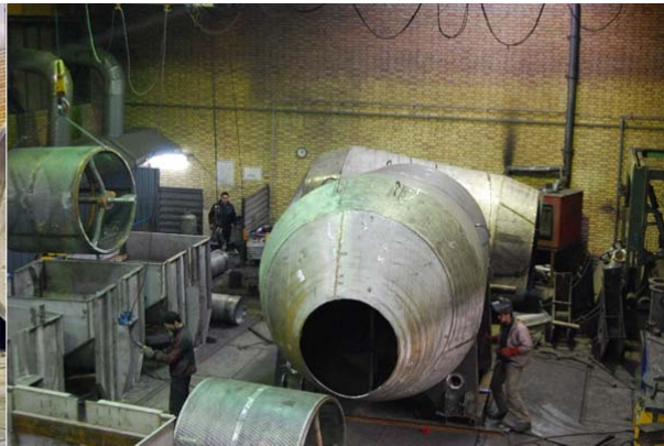
انواع مخازن و راکتورهای مواد شیمیایی از استیل ضد زنگ
